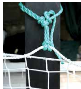
TN14 fune di ancoraggio in poliestere diam. mm 12 con asola piombata all'estremità, dimensione mt. 2, carico di rottura minimo 3000 kg.
