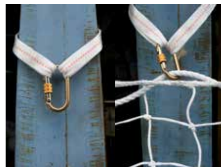
TN15 tirante di ancoraggio in poliestere, nastro bianco con riga arancio, altezza mm 35, lunghezza cm. 100 con asole da cm.15 alle estremità, carico di rottura 1800 kg. La rete nell'immagine è l'art. RS6
