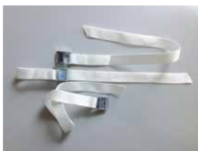
00320 tiranti/blizz altezza mm 25, lunghezza cm.50, nastro poliestere ht bianco, con fibbia in acciaio,carico di rottura minimo 800 kg
