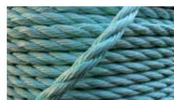
TN12 - fune di bordo in poliestere diam. mm 12, carico di rottura minimo 3000 kg.
