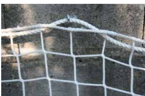
00315 - ancorante con gancio a ricciolo per reti di sicurezza, con tassello da mm 75 \varnothing del foro mm 18, filetto 12 mm, applicazioni su calcestruzzo, pietra naturale, mattone pieno distanza massima di ogni punto di ancoraggio 2,5 mt. La rete nell'immagine è l'art. RS8
