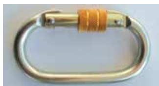
87MOACC moschettone ovale, acciaio, blocco di sicurezza a ghiera, certificato ce 0120 23kn en362:20048
