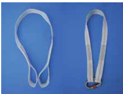
TN15 tirante di ancoraggio in poliestere, nastro bianco con riga arancio, altezza mm 35, lunghezza cm. 100 con asole da cm.15 alle estremità, carico di rottura 1800 kg. La rete nell'immagine è l'art. RS6
