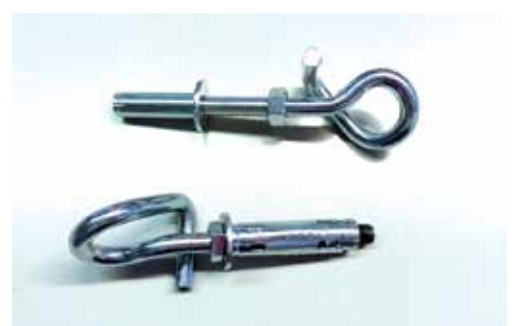
00315 - ancorante con gancio a ricciolo per reti di sicurezza, con tassello da mm 75 \varnothing del foro mm 18, filetto 12 mm, applicazioni su calcestruzzo, pietra naturale, mattone pieno distanza massima di ogni punto di ancoraggio 2,5 mt. La rete nell'immagine è l'art. RS8
