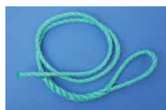
TN14 fune di ancoraggio in poliestere diam. mm 12 con asola piombata all'estremità, dimensione mt. 2, carico di rottura minimo 3000 kg.
