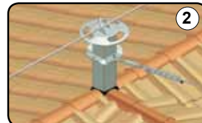
Modalità di fissaggio per ridurre i momenti flettenti sulla struttura di supporto
