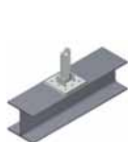
Saldatura (previa rimozione della zincatura)
